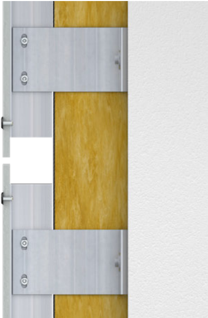
junta de perfil = junta de placas
