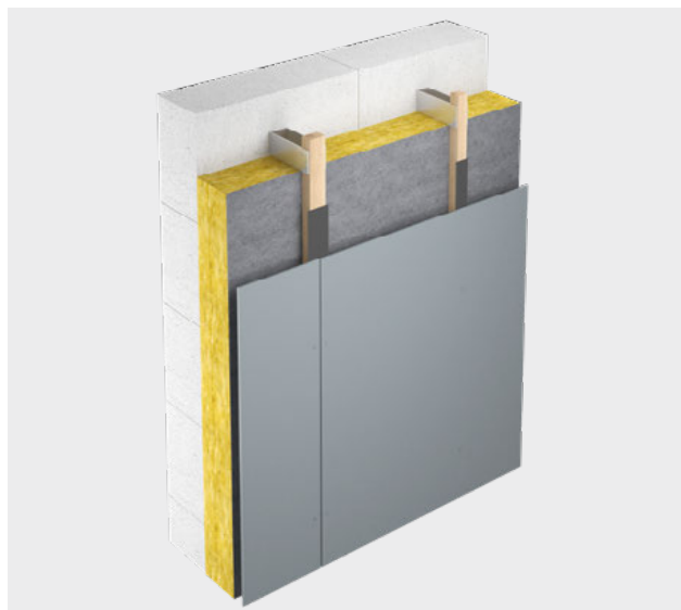
Subestructura de madera con distanciadores
