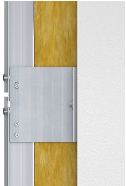
Fijación de dos perfiles a la misma escuadra (uno fijo y el otro deslizante), encuentro de perfiles oculto por los paneles
